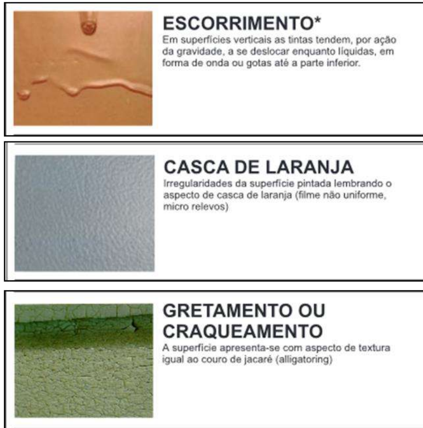
Figura 5.26 Diluição Inadequada – A figura ilustra três problemas frequentes que acontecem quando a diluição é inadequada, ou seja, quando a viscosidade da tinta é ajustada abaixo ou acima do ideal para ser aplicada sobre a superfície.
