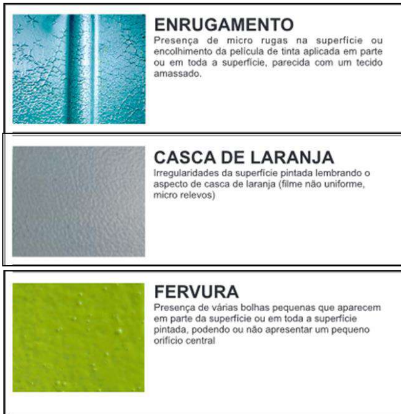
Figura 5.24 Diluição da Tinta com o Diluente não Recomendado – A figura ilustra três problemas frequentes que acontecem quando a tinta é diluída com um solvente muito volátil, ou que apresenta compatibilidade limitada com a resina. A escolha do solvente certo é imprescindível.
