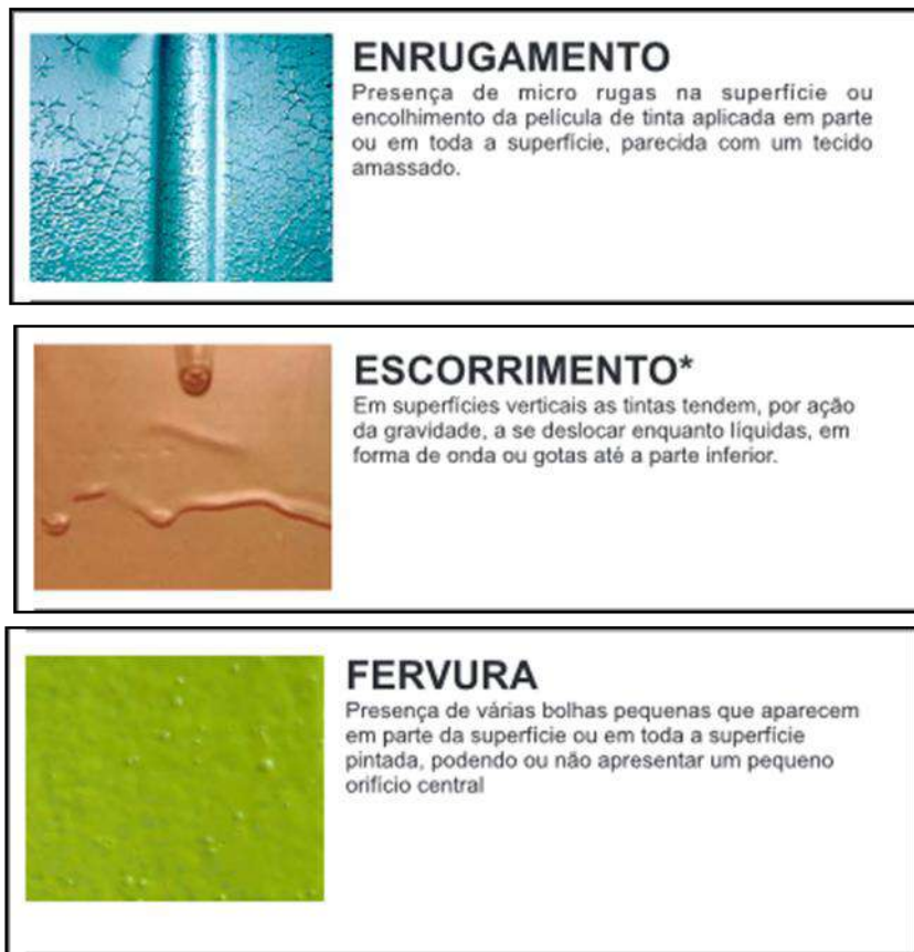
Figura 5.23 Aplicação da Tinta com o Filme muito Espesso – A figura ilustra três problemas frequentes que acontecem quando o filme de tinta é aplicado com espessura elevada. Essas imperfeições na superfície interferem na avaliação do desempenho do produto, sendo necessária a reaplicação.
