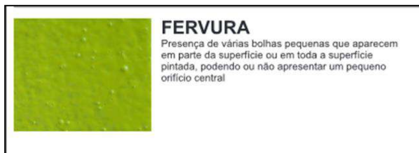
Figura 5.30 “Flash Off “ - A figura ilustra o problema que acontece quando a tinta aplicada é diretamente conduzida para a estufa, onde a cura é processada. Segundo o procedimento, a tinta deve ser mantida a temperatura ambiente por no mínimo cinco minutos, para permitir que os solventes mais voláteis evaporem antes da secagem da superfície do filme.
