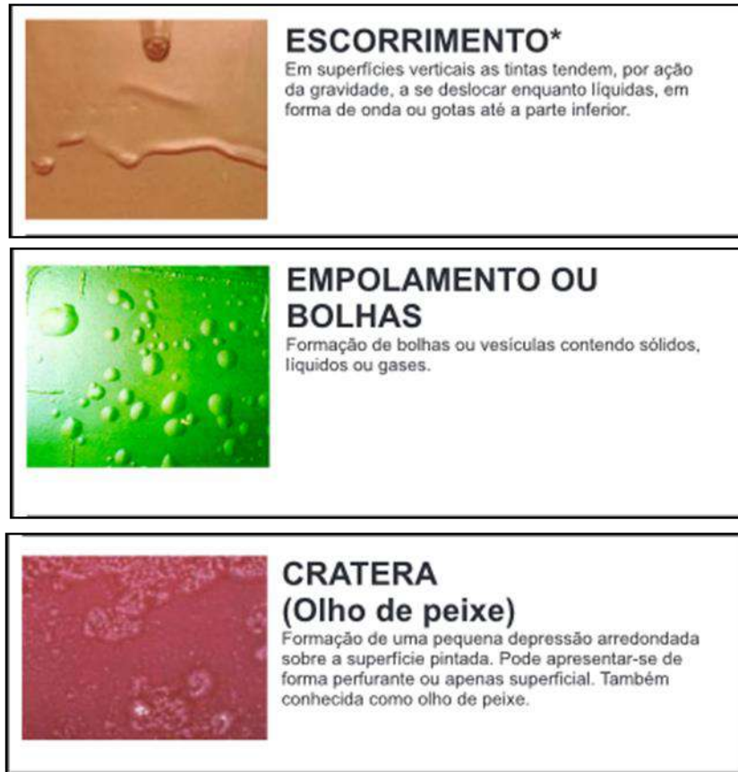
Figura 5.27 Homogeneização Ineficiente – A figura ilustra três problemas frequentes que acontecem quando a tinta não é homogeneizada de forma adequada, não incorporando de forma eficiente seus ingredientes.
