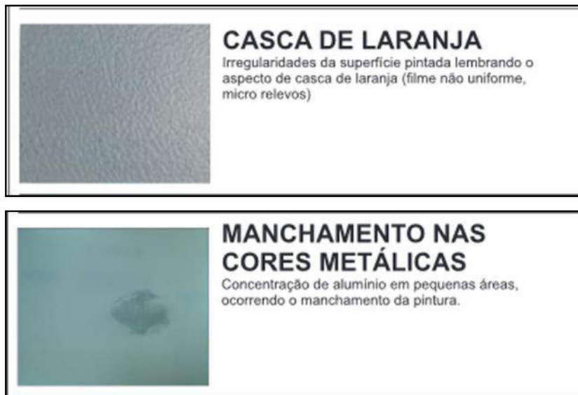
Figura 5.28 Regulagem Inadequada da Pistola de Pulverização – A figura ilustra dois problemas frequentes que acontecem quando a pressão do ar e o bico aspersor da pistola de pulverização não são regulados adequadamente. A operação do equipamento exige experiência e treinamento do operador.
