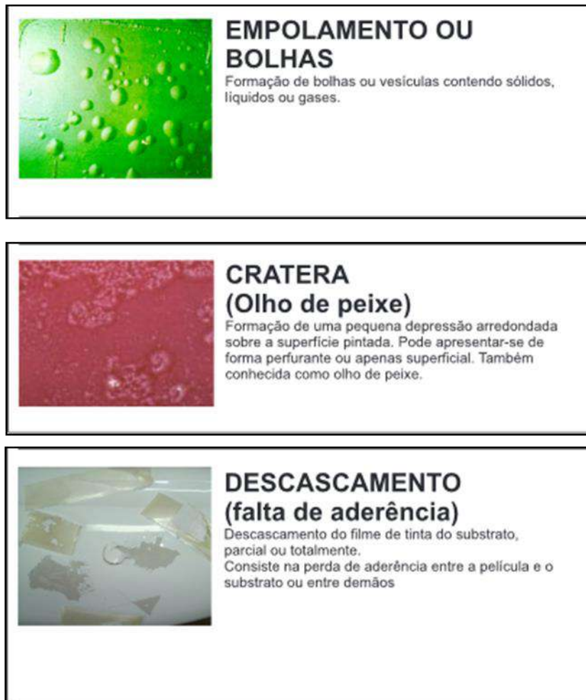
Figura 5.29– Superfície mal Preparada ou Oleosa - A figura ilustra três problemas frequentes que acontecem quando a superfície não é limpa adequadamente, apresentando partículas sólidas ou resíduo oleoso. A falta de aderência também pode ser causada por falta de lixamento, artifício utilizado para obter uma superfície rugosa.
