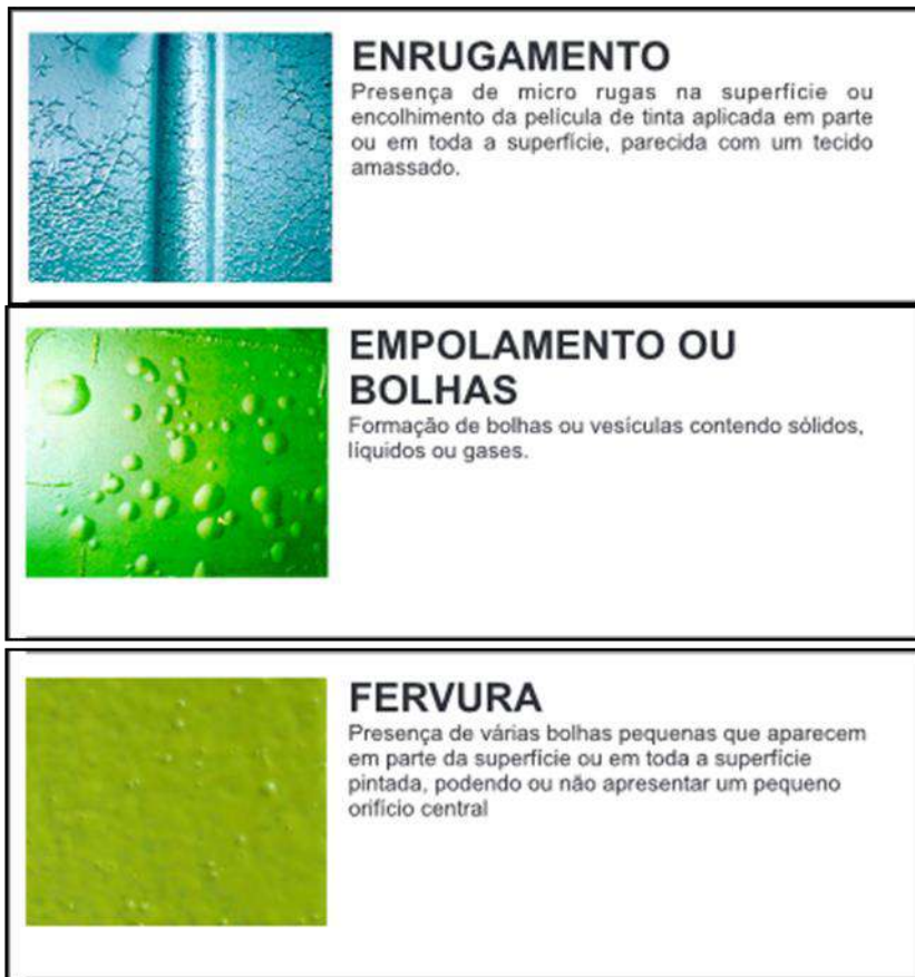
Figura 5.25 Secagem Superficial muito Rápida – A figura ilustra três problemas frequentes que acontecem quando a secagem da tinta é muito rápida, causada pela diluição com um solvente muito volátil, ou quando o tempo de flash off não é respeitado, ou seja a secagem é prematuramente acelerada na estufa.
